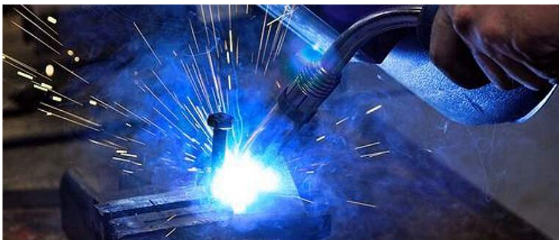
Образование микродисперсной металлической пыли в результате сварки
